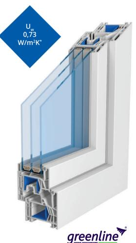
(\*) Der Uw Parameterwert beträgt 0,73 W/(m²k) für Referenzfenster mit den Abmessungen 1230 x 1480 mm. Für die Berechnungen wurde angenommen: a) dreifacher Glasscheiben-Set mit einer Dicke von 48 mm, b) Wärmedurchgangskoeffizient der Glasscheibe von Ug = 0,5 W/(m²K), c) linearer Wärmedurchgangskoeffizient des Zwischenscheibenrahmens psi=0,03 W/(m²K), d) Stahlverstärkung V 300 (Rahmen) und V 303 (Flügel).
